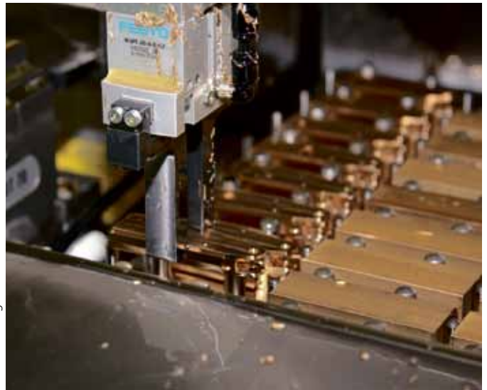
Das Handling ist für die 6-seitige Bearbeitung ideal gelöst. Gut zu erkennen die Stapel-Anordnung der Roh- und Fertigteile in der Modulbox.
