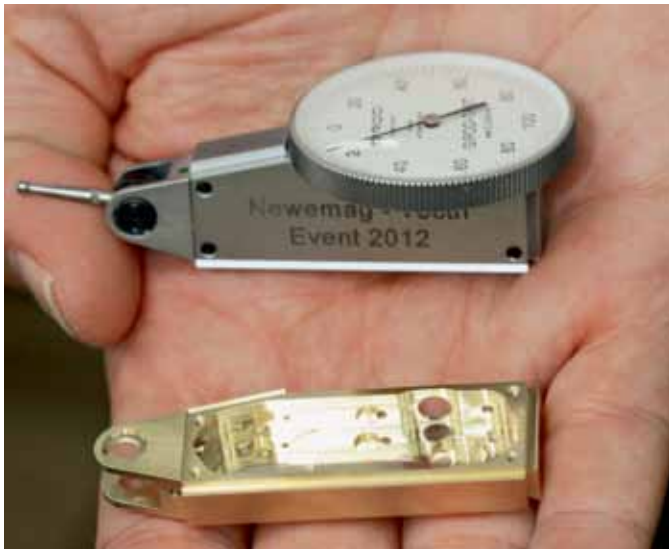
Ein fertig montierter Girod-Messtaster, darunter das Gehäuse, das neu in 15000er-Losgrößen auf zwei Brother-BAZ mit Modulbox 24 Stunden am Tag, 7 Tage die Woche rund um die Uhr gefertigt wird, fast mannlos.
