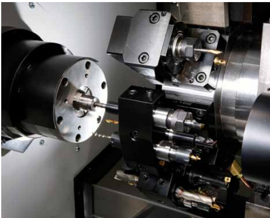
Blick in den Innenraum: Die Miyano BNA-42 DHY mit zwei Revolvern, Haupt- und Gegenspindel, y-Achse und angetriebenen Werkzeugen ist für präzise und komplexe Bearbeitungen perfekt zugeschnitten.
