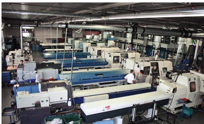
Blick in die Maschinenhalle bei Moser-Ingold AG mit den 18 Drehmaschinen und u.a. den drei 8-Achsen-CNC-Drehzentren ABX-64 SY von Miyano.
