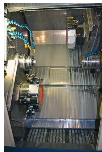
Maschinenraum eines Miyano-Drehzentrums ABX-64 SY mit der Hauptspindel (links) und der Gegenspindel (rechts) sowie mit den zugehörigen jedoch unten und oben liegenden Werkzeugrevolvern mit jeweils 12 angetriebenen Werkzeugen für die simultane Komplett- und Rückseiten-Komplettbearbeitung an beiden Spindeln.
