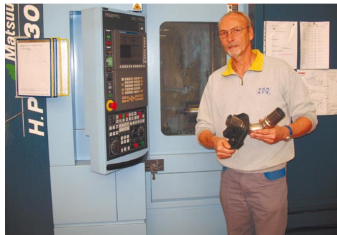
Peter Sutter, Meister Produktion bei Von Arx, zeigt, wie sich die Pressbacken um das Rohr-Verbindungsstück schliessen.
