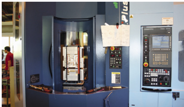
Palettenrüstplatz für die Beladung bzw. Entnahme von Werkstücken während der Bearbeitung.
