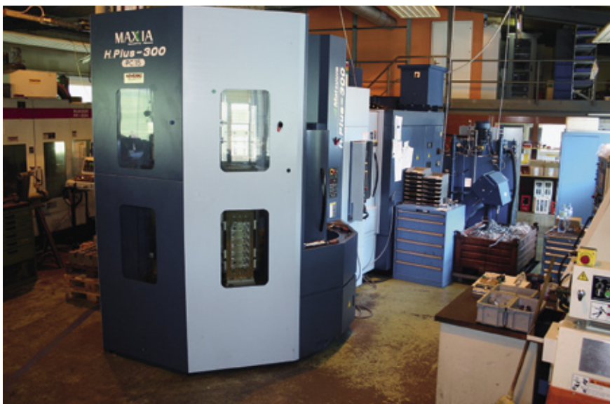
Gesamtansicht des kompakten Horizontal-Bearbeitungszentrums H-Plus-300 Matsuura mit dem Palettenspeicher (im Vordergrund) und dem Werkzeugmagazin (rechts).
