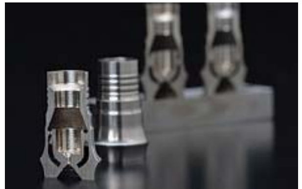
Nur mit Lumex in einer Aufspannung möglich: Triebwerksdüsen mit integrierten Kanälen und gefrästen Flächen. (Bild: Newemag)
