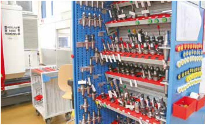
Sonderwerkzeuge sind in einem separaten Werkzeugmagazin gelagert und werden nur bei Bedarf eingewechselt.
