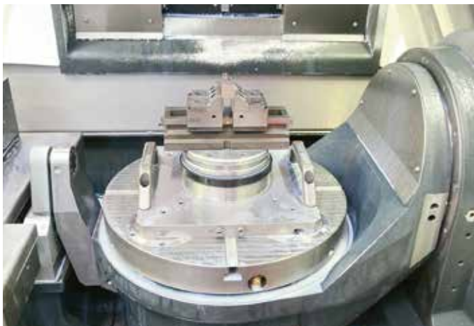
Die Dreh-Schwenktisch-Einheit der RS 505K ist durchgängig mit einem Nullpunkt-Spannsystem ausgestattet. Dadurch konnten die Rüstzeiten verkürzt werden.
