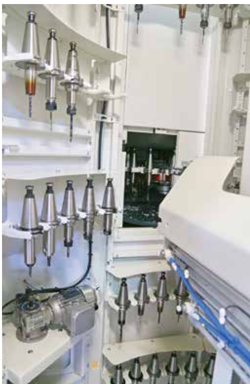
Stand-by-Magazin innen: Neben den 180 zusätzlichen Werkzeugplätzen sind 33 Werkzeuge direkt in der Maschine. Das Magazin ist mit einer Kegel-Reinigungsstation ausgestattet.
